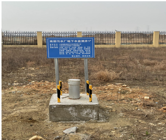
地下水监测井 1
