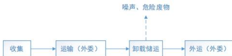
图 2-4 其他危废工艺流程及排污节点
